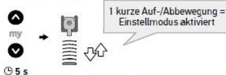
2 Halten Sie die Taste ▼ gedrückt (1 kurze Bewegung) und drücken Sie bei Annäherung an die Endlage die Taste **my**, um den Antrieb zu stoppen. Drücken Sie dann mehrmals kurz die Taste ▼, bis die gewünschte untere Endlage erreicht ist:
