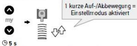
2 Halten Sie die Taste ▲ gedrückt (1 kurze Bewegung) und drücken Sie bei Annäherung an die Endlage die Taste **my**, um den Antrieb zu stoppen. Drücken Sie dann mehrmals kurz die Taste ▲, bis die gewünschte obere Endlage erreicht ist:
